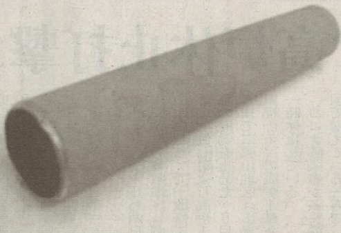
筒の中に軟エックス線が入射し、内面で反射しながら集光するミラ（三村・東大准教授提供）
